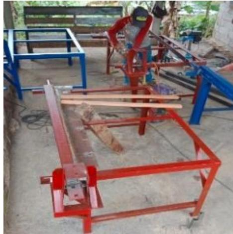
**Gambar 5.** Pembuatan Rangka Meja potong
