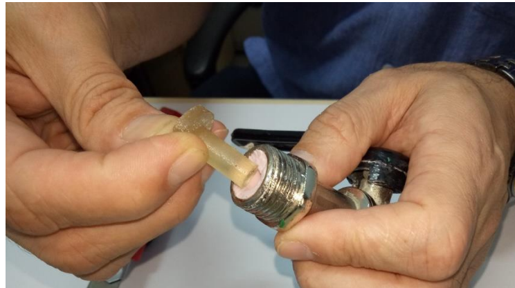
Gambar 2. Cara Pemasangan Alat Pembatas Aliran Air
