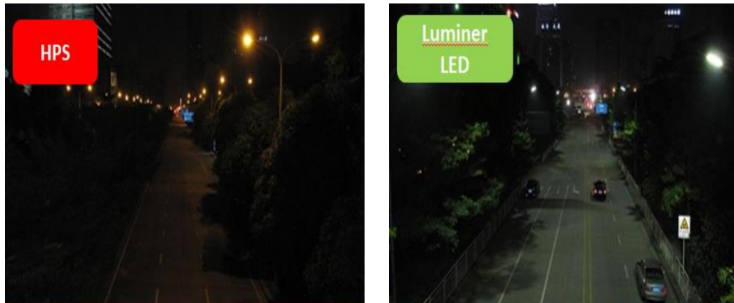
Gambar 2. Perbandingan PJU Menggunakan Lampu HPS dan Lampu LED [3]
