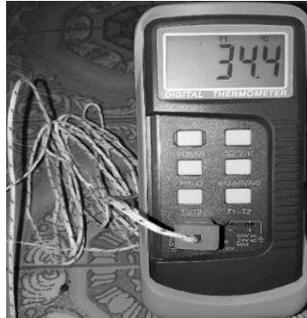
**Gambar 5.** *Digital Thermometer*
