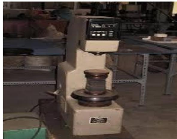
Gambar 10. Metode Uji Kekerasan *Brinell*
