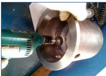
Gambar 10. Perbaikan Guide Bush
