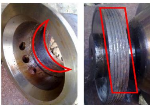
Gambar 5. Korosi Pada piston dan bush
