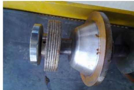
Gambar 11. Guide Piston setelah Perbaikan
