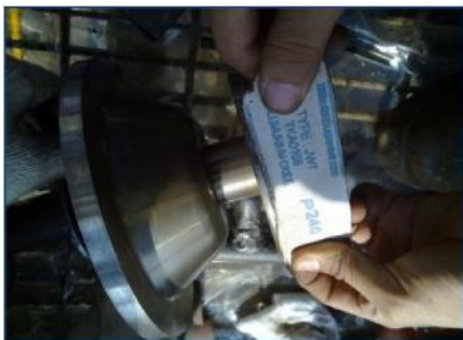
Gambar 9. Perbaikan Guide Piston
