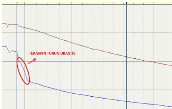
Gambar 4. Kondisi Penurunan Tekanan HP Drum setelah damper close
