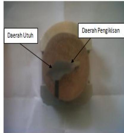
Gambar 7. Sampel Pengujian Uji Kekerasan
