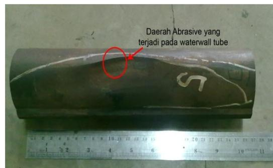
Gambar 5. Potongan Waterwall Tube yang Mengalami Pengikisan
