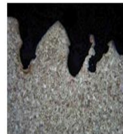
Gambar 5. Area hot stage (sisi api) mikroskop optik
