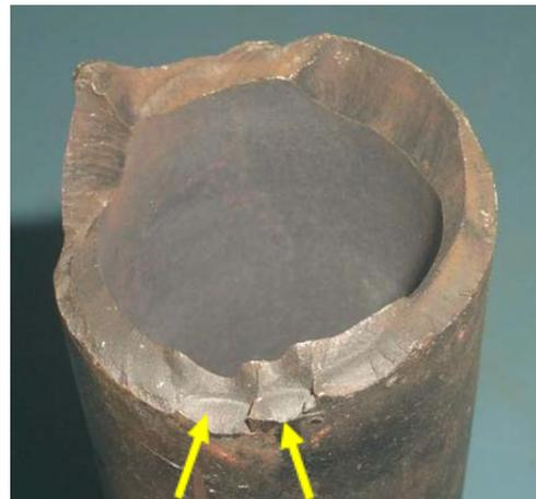
Gambar 9. Permukaan patah dari sampel pipa yang ditandai dengan anak panah
