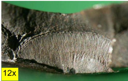
Gambar 11. Perbesaran lebih besar dari permukaan patah (*fracture*) yang ditunjukkan oleh Gambar 10 dengan perbesaran 12x
