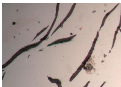
Gambar 1. Grafit eutetik lamellar (OM tanpa etsa)
