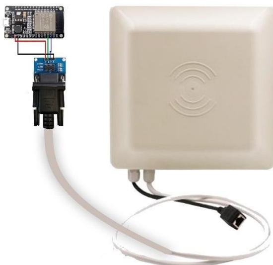
Gambar 5. Skematik rangkaian RFID reader
