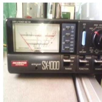
Gambar 5. SWR meter yang digunakan
