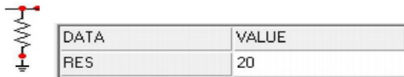
**Gambar 4.** Permodelan tahanan kaki menara dengan nilai resistansi 20 ohm
