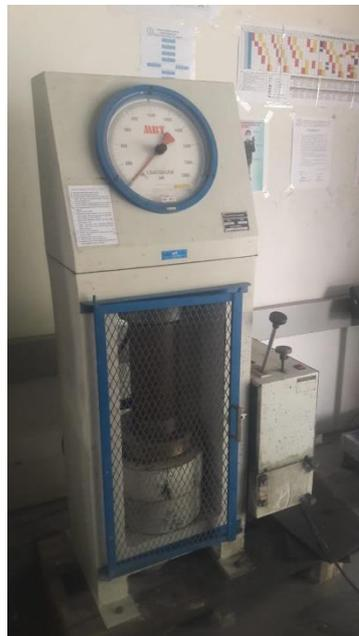
**Gambar 2.** Setting Up Pengujian Kuat Tekan Beton
