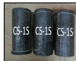
Gambar 24. Pola Runtuh Kolom Tabung Baja Kosong
