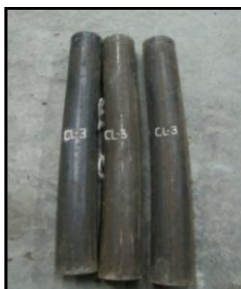
Gambar 21. Pola runtuh kolom komposit dengan L/D=8
