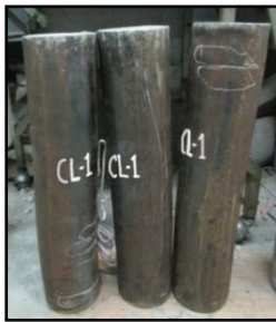
Gambar 19. Pola runtuh kolom komposit dengan L/D=4
