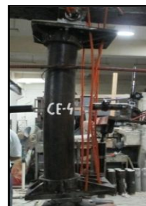
Gambar 23. Pola runtuh kolom akibat beban eksentris
