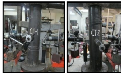
Gambar 22. Pola runtuh kolom komposit dengan D/t=57 mm dan D/t=45 mm
