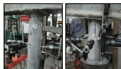
Gambar 25. Pola runtuh kolom dari inti beton saja
