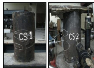
Gambar 18. Pola runtuh kolom komposit dengan L/D=2
