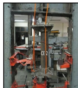
Gambar 6. Pengujian Aksial Eksentris
