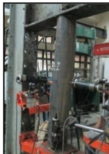
Gambar 20. Pola runtuh kolom komposit dengan L/D=6
