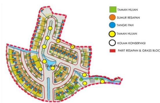
Gambar 16. Usulan Desain Perletakan Konsep *Zero Runoff*
