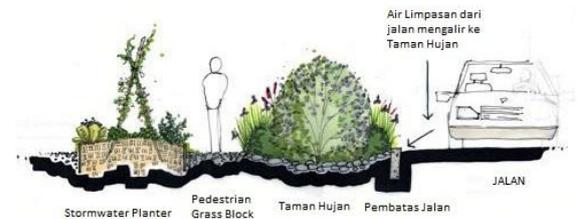
Gambar 14. Detail Taman Hujan pada sisi jalan Utama
