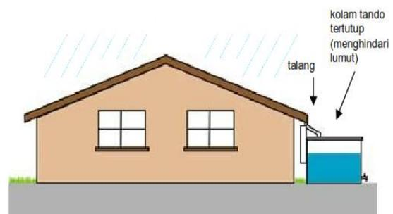
Gambar 1. Kolam Pengumpul Air Hujan di Atas Permukaan Tanah.
