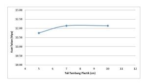
Gambar 3. Grafik Hubungan Kuat Tekan Beton Pada Umur 28 Hari dengan Penambahan Tali Tambang Plastik
