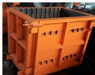
Gambar 3. Bekisting Knock Down (Sumber : Diolah Penulis 2017)
