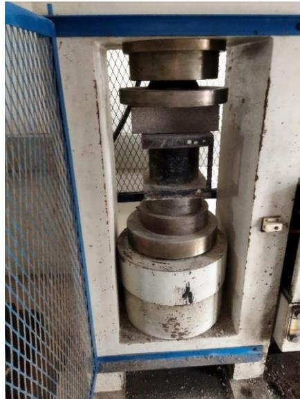
**Gambar 1.** *Setting Up* Pengujian Kuat Tekan Paving
