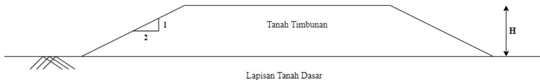
**Gambar 2.** Rencana Penampang Timbunan dengan Variasi Tinggi
