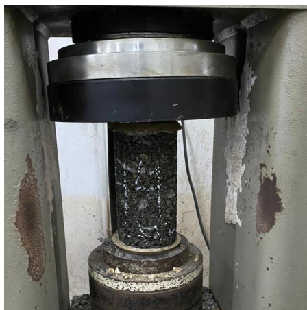
Gambar 3. Silinder Uji Kuat Tekan BPPR 20%
