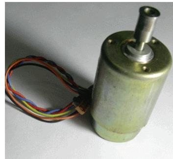
Gambar 2. Jenis Motor DC yang digunakan yaitu MTR-DSR01
