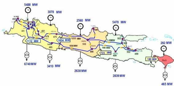
Gambar 2. 2 Sistem Saluran Transmisi Listrik Jawa-Bali (Sumber: PLN P3B Gandul)
