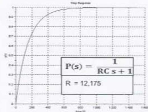
Gambar 4.6 Unjuk kerja aksi control P(s), belum menggunakan PID
