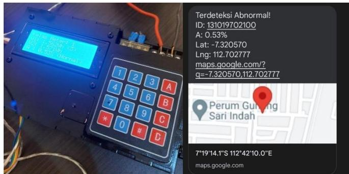
**Gambar 5.** Contoh Tampilan Parameter Kondisi kWh Meter pada LCD serta Notifikasi SMS
