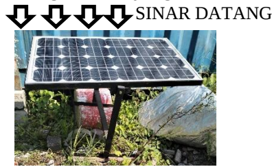
Gambar 5. Pengujian Panel Surya Sudut Tetap
