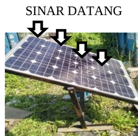
Gambar 4. Pengujian Panel Surya Sudut Diubah
