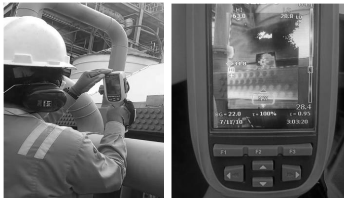
Gambar 3. Pengambilan Paramter Outler Cooler Air Fan
