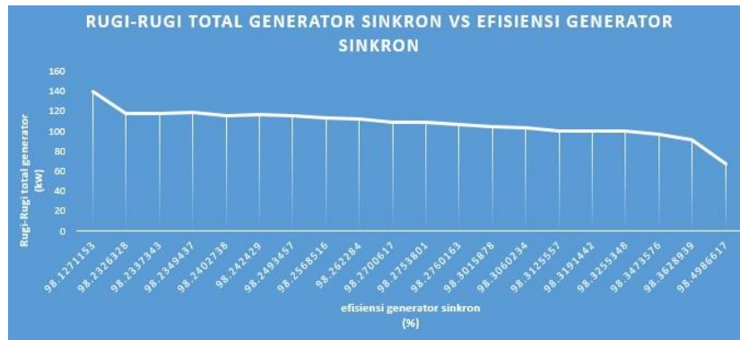
Gambar. 5. Kurva hubungan efisiensi generator terhadap rugi-rugi total generator sinkron
