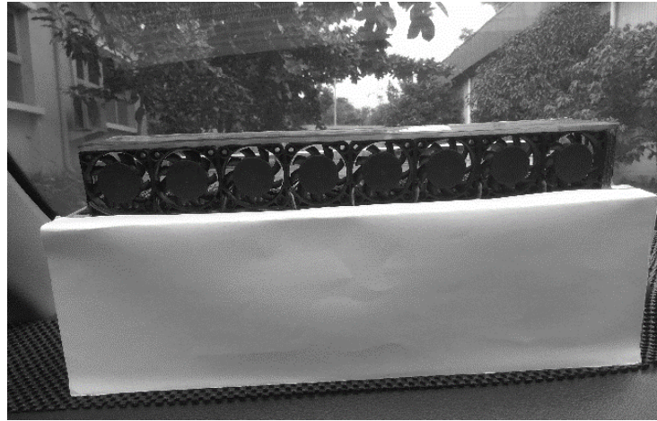
Gambar 5. Posisi Alat Penghilang Embun Kaca Depan Pada Kendaraan.
