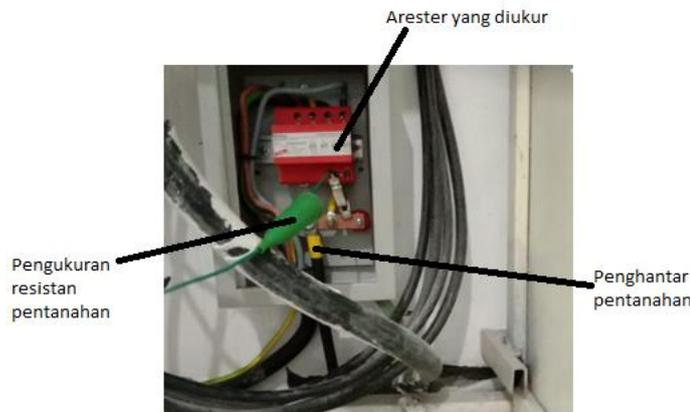
Gambar 6. Pengukuran arrester
