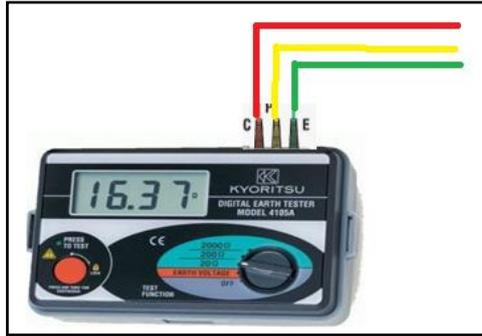
Gambar 5. Earth meter dengan warna probe
