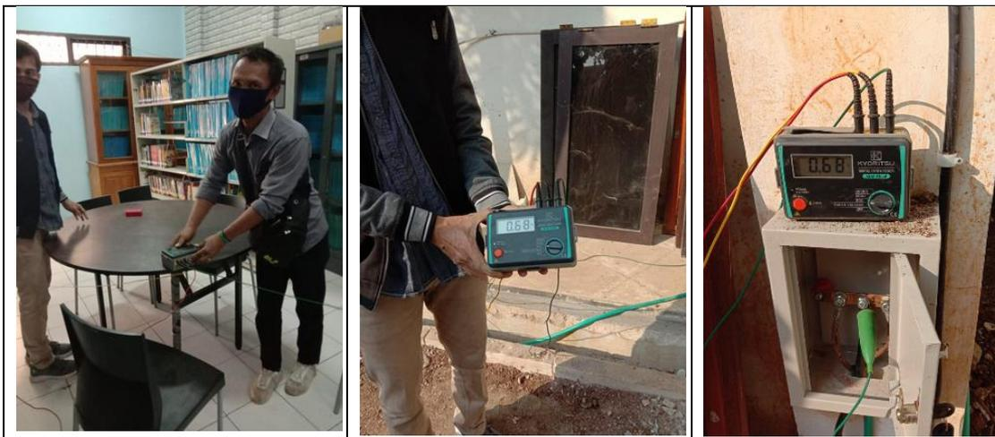
**Gambar 7.** Foto pengukuran resistan pentanahan
